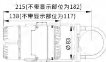
水平配管连接方式 (侧面)
